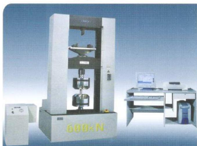
微机控制电液伺服液压万能试验机
